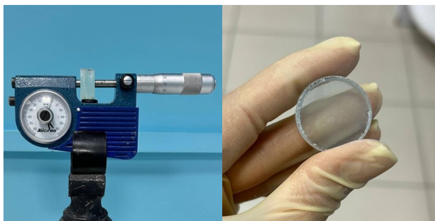
Рисунок 2.2 – Измерение толщины двух склеенных цементом стеклянных пластин
